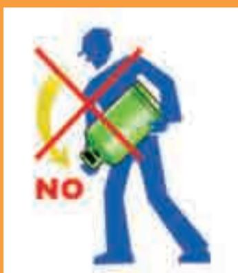
La bombola deve rimanere sempre verticale, con il rubinetto in alto. La sostituzione della bombola deve essere eseguita con il rubinetto chiuso. Non bisogna effettuare la sostituzione in presenza di fiamme, scintille o apparecchi elettrici in funzione. I tubi che sono collegati alla bombola devono essere cambiati ogni 5 anni. La bombola vuota non deve essere gettata o abbandonata ma va riconsegnata al rivenditore dal quale si acquista la bombola piena.
