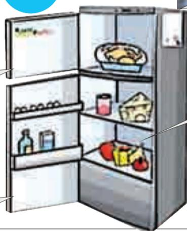
Lasciate 10 cm di spazio tra la parte posteriore del frigorifero e il muro. Nel caso di apparecchio a incasso, assicuratevi che vi sia spazio per un'adeguata ventilazione.
