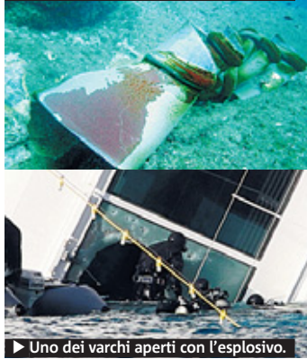
► Uno dei varchi aperti con l'esplosivo.
