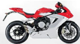
za: Sport, Normal, Rain e Custom. E interviene sul "set up" del freno motore. Il motore è un 3 cilindri di 675 cc, albero controrotante, 128 CV a 14.400 giri. Peso: 173 kg a secco. Prezzo: 12.190 euro.
