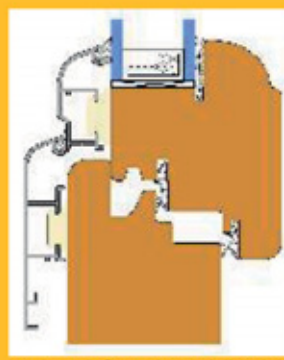
sezione infisso legno/alluminio
