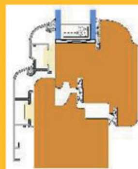
sezione infisso legno/alluminio
