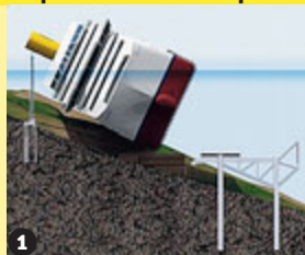
1 Stabilizzazione del relitto. Fase quasi completata.
