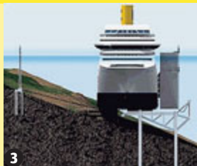
3 Riassetto verticale del relitto detto Parbuckling.
