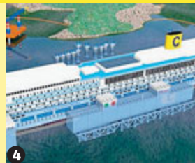
4 Rigalleggiamento. La Concordia potrà essere portata via.
