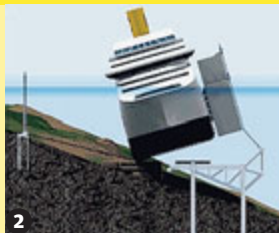
2 Costruzione del falso fondale e dei cassoni su di un lato.
