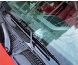
della maggiore flessione alla quale viene sottoposta la pellicola di pvb, un materiale sensibile e molto particolare, che si trova fra i due strati del parabrezza. Non a caso, il numero delle sostituzioni dei parabrezza aumenta proprio in coincidenza con le alte temperature ambientali. Per quanto riguarda l'impianto elet-
