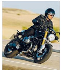
elettronica rivista e terminale più leggero. Inedito il telaio con forcella tradizionale e non Telelever. Vera opera d'arte il serbatoio in alluminio assemblato da maestri saldatori. A 15.500 euro.
