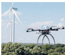
**SPAGNA** Una società spagnola, la Arborea Intelbird, spin off dell'Università di Salamanca, ha ideato un drone ("Aracnocóptero") in grado di monitorare dall'alto il funzionamento dei rotor. Volando lungo la superficie del parco eolico
