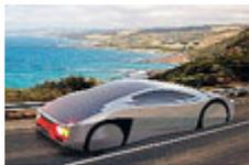
Si chiama Immortus la due posti ad energia solare prodotta dalla EVX Ventures di Melbourne. Può viaggiare ininterrottamente, senza la necessità di essere attaccata alla corrente, percorrendo distanze illimitate a patto che splenda il sole. Tutto grazie ai 7 metri quadri di pannelli fotovoltaici che ricoprono le sue lamierine. È lunga 5 metri, alta 1.10 e pesa 550 chili. Di notte, o quando non splende il sole, ha un'autonomia di 400 chilometri. (Francesco Paniè, Rinnovabili.it)
