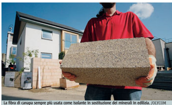
La fibra di canapa sempre più usata come isolante in sostituzione dei minerali in edilizia. /OLYCOM
