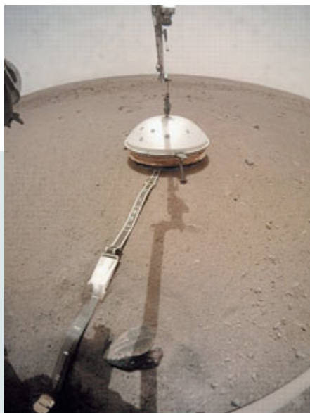
Posizionato il cupolino di protezione del sismografo. /NASA
