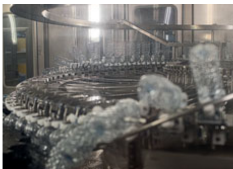
IL PROCESSO DI PRELAVAGGIO DELLE BOTTIGLIE DI PLASTICA
