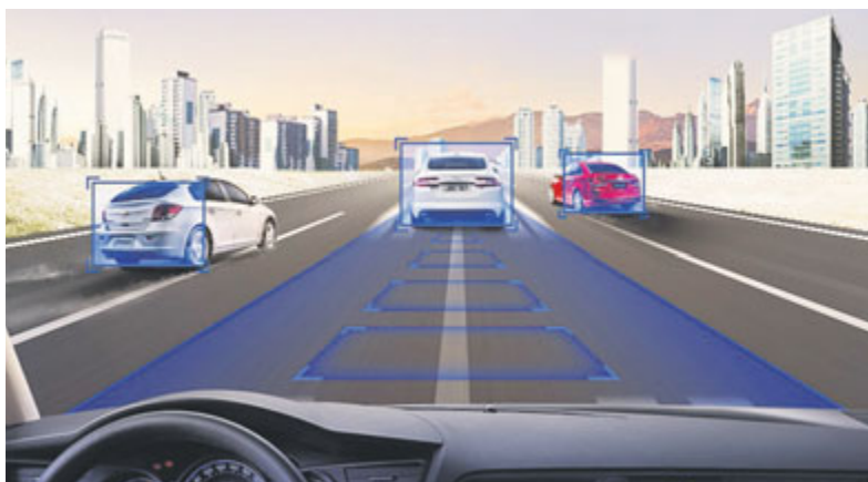
LDWS produce un segnale acustico nel momento in cui il guidatore oltrepassa pericolosamente la linea di corsia
