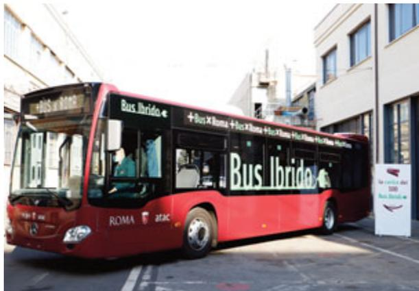
emissioni inquinanti rispetto ai bus che verranno sostituiti. Oltre alla classe energetica, i 100 mezzi in arrivo hanno caratteristiche di tutto rispetto anche dal punto di vista del comfort: sono autobus classe I urbani da 12 metri ibridi con motorizzazione diesel Euro 6, tutti dotati di cabina protetta, climatizzazione e pedana manuale per i portatori di disabilità e di tutti gli standard
