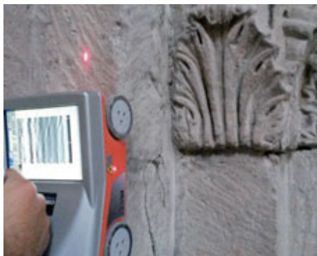
UN GEORADAR PER L'ANALISI DELLE COLONNE DEL DUOMO DI VITERBO
