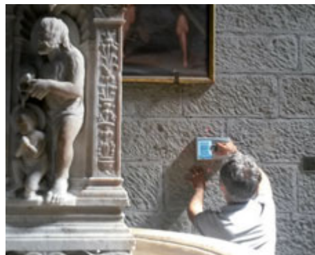
UN GEORADAR AD ALTA FREQUENZA PER L'ANALISI DELLE STRUTTURE
