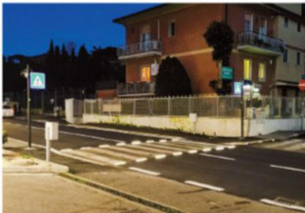
Dopo viale Isacco Newton e via di Pietralata, le nuove strisce pedonali a led progettate da Roma Servizi per la Mobilità sono entrate in funzione anche in via del Fosso di Bravetta all'altezza di via degli Amodè. Dalle prime ore del crepuscolo e per tutta la notte illuminano una parte importante della strada che collega via di Bravetta con via della Pisana. Le installazioni proseguiranno in via Casilina, all'altezza della stazione Borghesiana della metro C.
