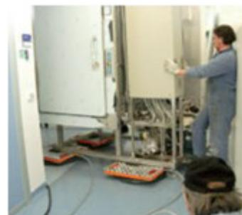
mini strato di aria sopra il terreno, in modo da permettere ai macchinari di fluttuare senza ricevere sbalzi e contraccolpi. Grazie a Levitrans di MA.NI.MA. Srl è possibile sollevare pesi fino a 40 tonnellate su pavimenti lisci, senza rovinare i pavimenti stessi e la merce.
